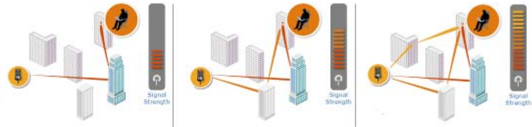
图 3：波束合成技术工作原理
